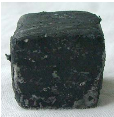
Application de la patine sur le pavé. La couche est épaisse et doit bien remplir les parties creuses de la pièce pour un meilleur effet.
